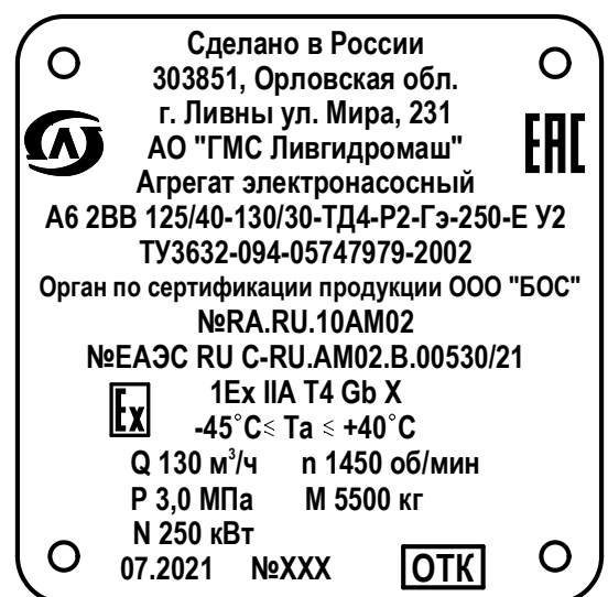
Рисунок 6 – Фирменная табличка (пример оформления)
