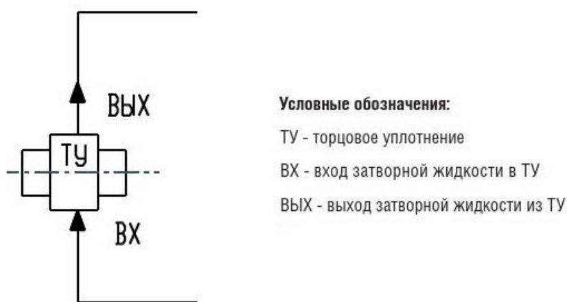
Рисунок 3 - Схема обвязки двойных торцовых уплотнений 52
