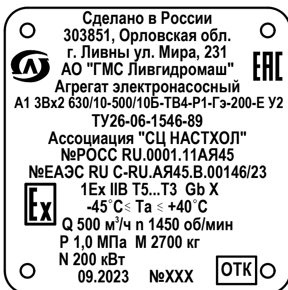
Рисунок 4 – Firmenная табличка (примеры оформления)
